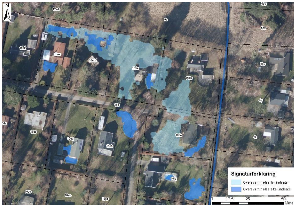
Figur 2-57 Oversvømmelse i S11.3 før og efter indsats ved etablering drænledninger med udløb i Højbro Å ved en 100 mm regnhændelse.
