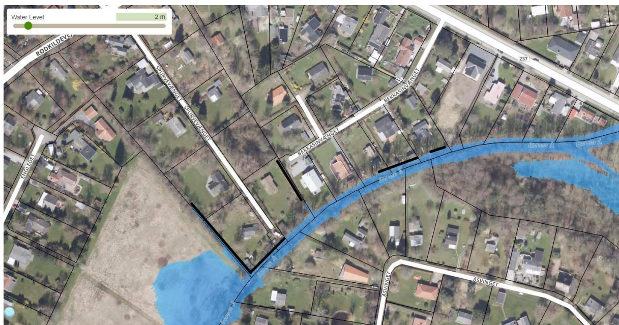
Figur 2-35 Tilagsstrækninger for hækning af terræn lokalt omkring Esrum Å. Oversvømmelse ved 2,0 m havvandstand fremgår med blåt. /9/
