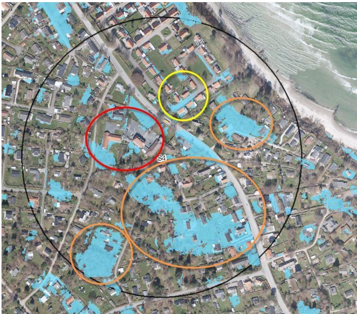
Figur 2-37 Oversvømmelse ved 100 mm regn. Munkerup Behandlingshjem er markeret med en rød cirkel. Fællesvej i Munkerup Have er markeret med gul. Yderligere problem områder er markeret med orange.
